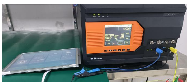
3.2 EFT test
