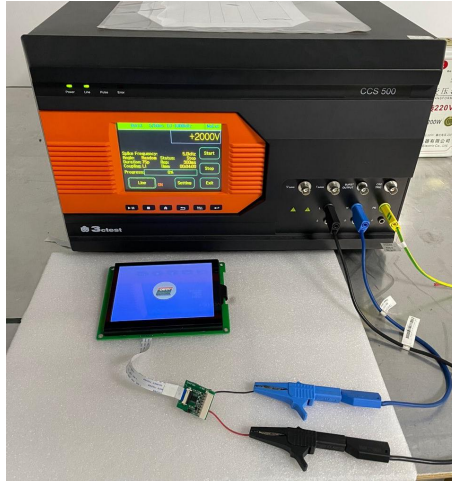
3.2 群脉冲测试图 EFT test
